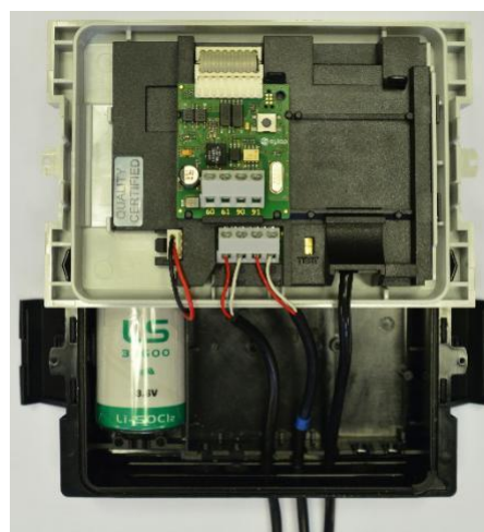
Picture 5.2 - Modul installerad i mätare
