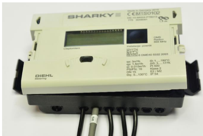
Bild 5.8 - Stängning av kapsling från vänster kant
